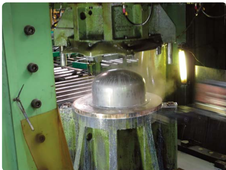
Bild 2: Fertiges Oberteil eines Druckausdehnungsgefäßes
