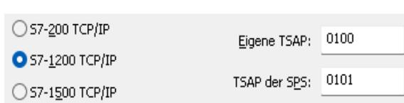
Sollen eine S7 200/ 1200/ oder 1500 CPU die über einen TCP/IP Port verfügt verbunden werden, kann die CPU direkt ausgewählt werden. Sollte die Verbindung über ISO on TCP erfolgen sind die eigene und die TSAP der SPS (CPU) anzugeben.
