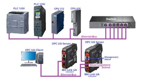
Für eine OPC UA Server-Redundanz einzurichten sind mindestens zwei (2) IBH Link UA erforderlich. Diese OPC UA Server müssen weitgehend eine identische Konfiguration (unterschiedliche IP-Adressen, Hostnamen usw.) haben.
