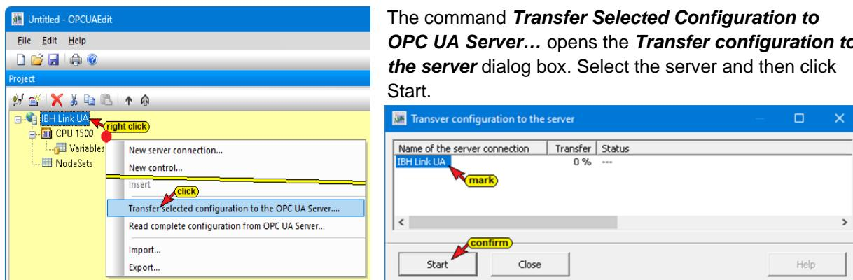
If the configuration is transferred from the IBH OPC UA Editor to the IBH Link UA (OPC UA Server), the OPC tags present in the OPC UA server (displayed in the Siemens Slots window).
